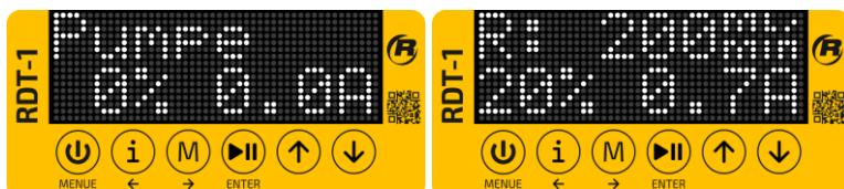
Wird die Pumpe aktiviert, kann die Leistung mit den Pfeiltasten verändert werden. Das Ventil wird automatisch ein- oder ausgeschaltet, damit das Medium fließen kann. Die Pumpe muss ausgeschaltet werden, damit ein Wechsel zu den anderen IOs über die Pfeiltasten wieder möglich ist.
