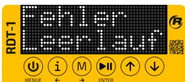
Die Funktion Leerlauf kann mit 2 Parametern eingestellt werden und ist im Betrieb „Normal“ und „Charge“ aktiv. Wird ein Leerlauf erkannt, stoppt das Dosieren und der Fehler wird angezeigt.
