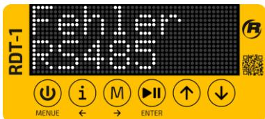
Erfolgt keine Kommunikation zwischen Bedienteil und Leistungsteil, wird dieser Fehler angezeigt. Gründe hierfür können sein: Schnittstelle nicht aktiviert, falsche Einstellungen oder Buswiderstand erforderlich.
