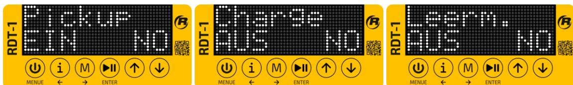
Angezeigt wird der aktuelle Zustand des Eingangs sowie der aktuell eingestellte Eingangstyp. „NO“ steht für „Normal open“ und definiert einen Schließer. „NC“ bedeutet „Normal closed“ und definiert einen Öffner.
