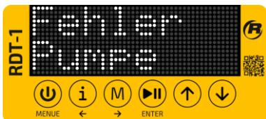
Im Leistungsteil wird der Strom der Pumpe dauernd gemessen. Ist der Strom höher als eingestellt, kann dieser Fehler auftreten. Ein möglicher Grund kann sein, dass die Pumpe blockiert und einen zu hohen Strom aufnimmt.
